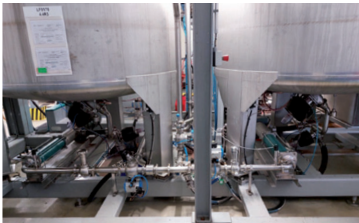
Bombas con maior caudal e cun acceso axeitado acorde á ergonomía.
